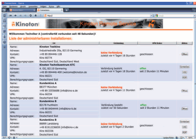
Remote Desktop Session: Sobald sich der Servicetechniker über das Technikerportal des Kinoton Remote Service Servers (Bild links) in den zu servicerenden Bildwerferraum eingeloggt hat, kann er über das lokale Ethernet (Netzwerk-Datenleitungen, bei einem internen Netzwerk auch LAN oder Local Area Network genannt) mit dem Remote-Service-PC bzw. der KRS-Box verbunden. Auf kurze Entfernungen bis zwei Meter können die D-Cinema-Komponenten auch über USB-Kabel oder serielle Schnittstelle (RS-232) angeschlossen werden.
